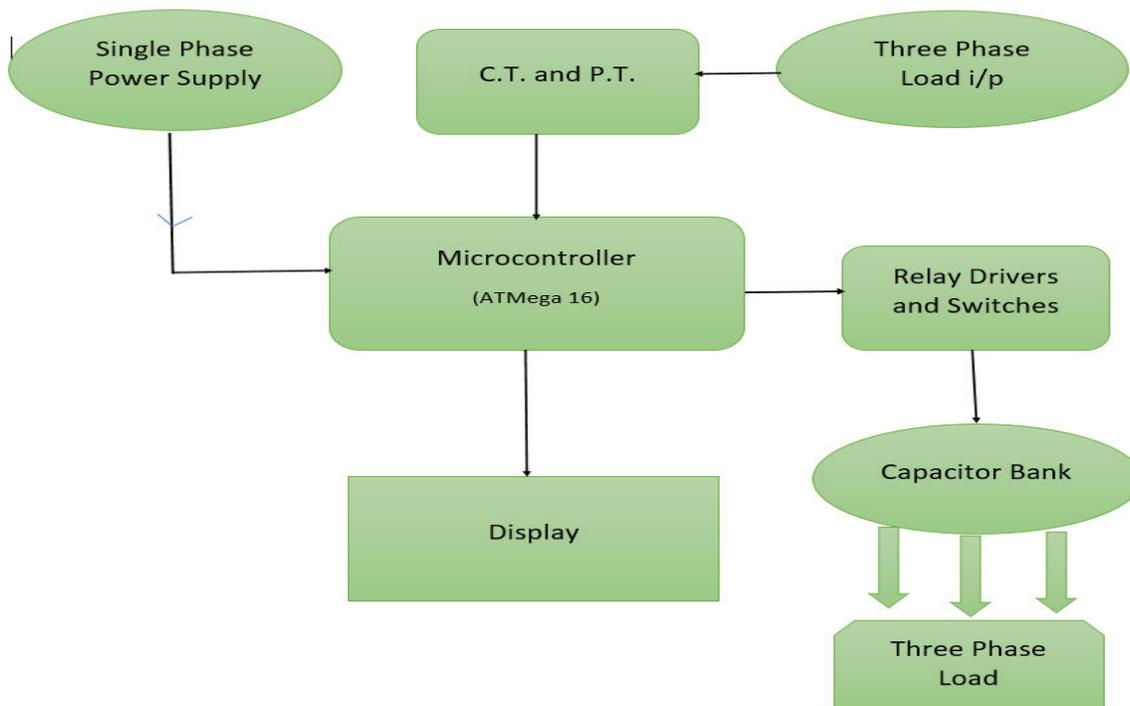
Figure (1). Block Diagram
